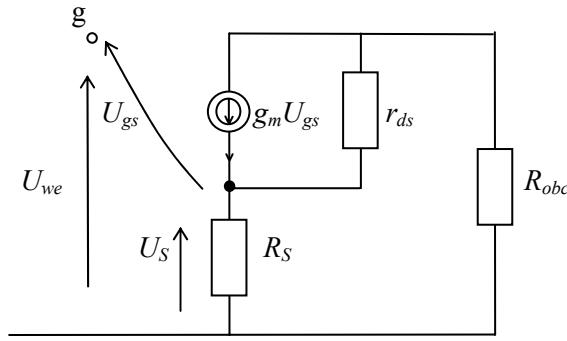
$$U_S = g_m U_{gs} r_{ds} \parallel (R_S + R_{obc}) \frac{R_S}{R_S + R_{obc}} = g_m U_{gs} \frac{r_{ds} R_S}{R_{obc} + R_S + r_{ds}}$$
